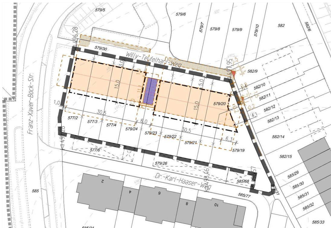
Abb. 3: Abstandsflächen nach BayBO, BRAUN: auf öffentlichen Flächen (über der Mitte), BLAU: Überlappungen und ROT: Fremdgrundstücken
